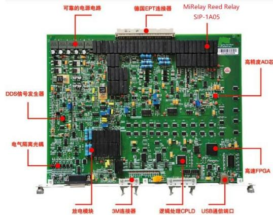
件的电性能及电气连接进行测试来检查生产制造缺陷及元器件不良的一种标准测试手段。它主要检查在线的单个元器件以及各电路网络的开、短路情况，具有操作简单、快捷迅速、故障定位准确等特点。
