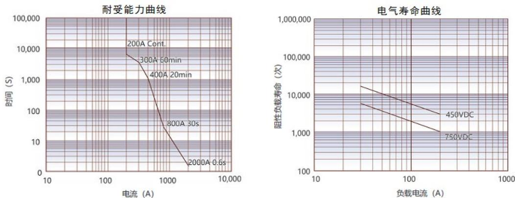
备注：1)耐电流测试在连接导线截面积 $\geq 60\text{mm}^2$ 条件下，数据仅作参考，请勿直接用于选择熔断器。
